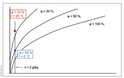
Abbildung 1: Veränderung der relativen Luftfeuchte bei sich ändernder Temperatur und konstanter Wasserbeladung
