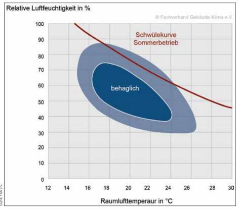
Abbildung 3: Kennfeld der Behaglichkeit in Abhängigkeit von Raumlufttemperatur und relativer Feuchte
